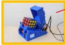
これがルービックキューブ揃え機 (3Dプリンターで作製！)
